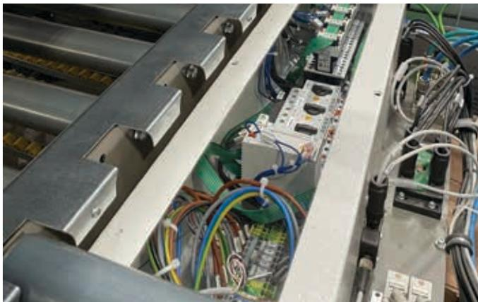
Cablaggio SmartWire-DT per la gestione intelligente dell'avviamento del nastro trasportatore
